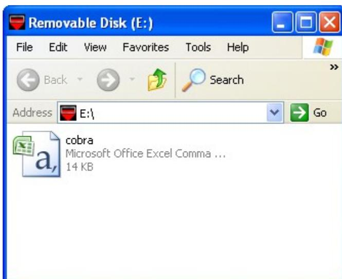
Vous êtes maintenant prêt à charger votre script dans la COBRA 18R2. Pour cela, connectez simplement la clé USB dans la 18R2. Si il n'y a pas d'erreur, les 18 LEDs des lignes s'allumeront en vert. Si des erreurs sont présentes dans votre fichier, les LEDs des lignes s'allumeront en rouge et les codes d'erreur / numéros de ligne seront affichés successivement.
